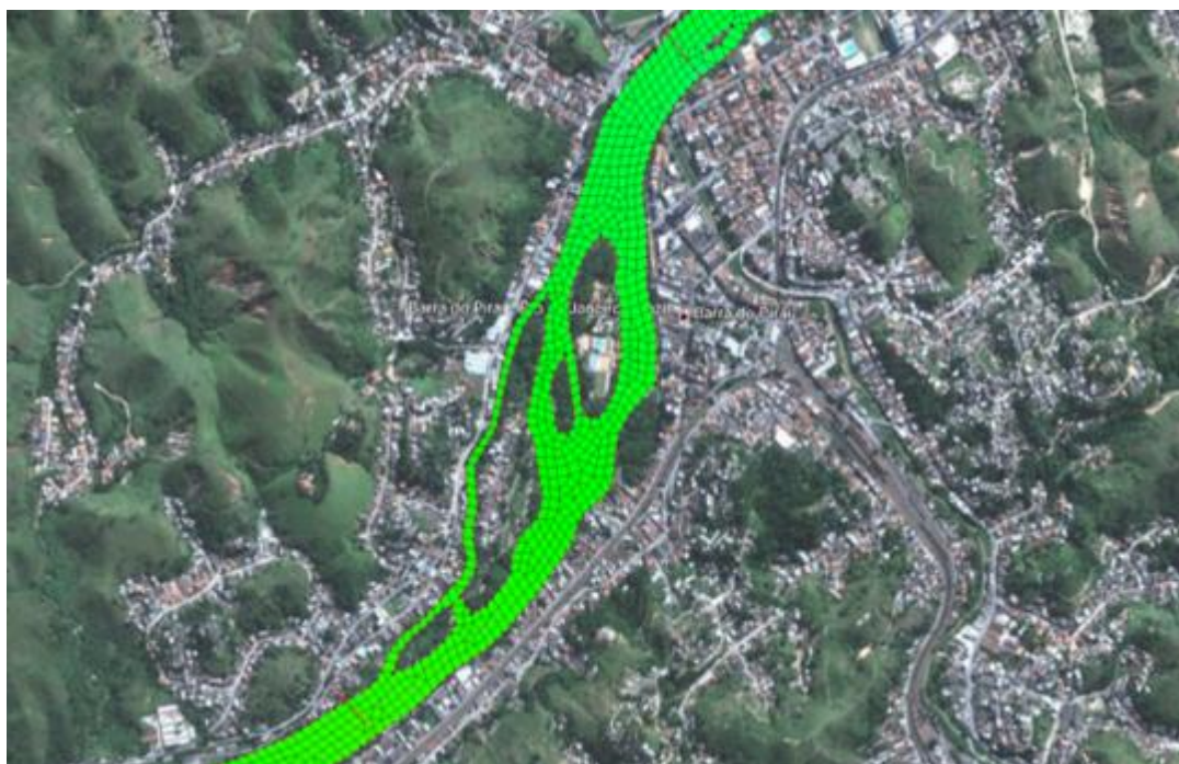
Figura 3: Detalhe da malha do modelo hidrodinâmico para o Rio Paraíba do Sul – Barra do Pirai.
