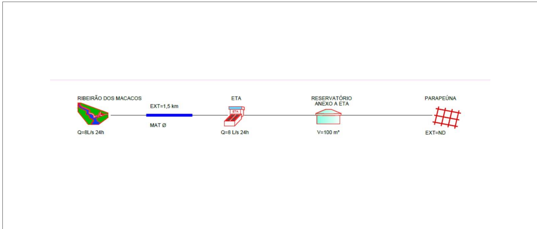
Figura 8 – Esquema do sistema de abastecimento de água no distrito de Parapeúna
