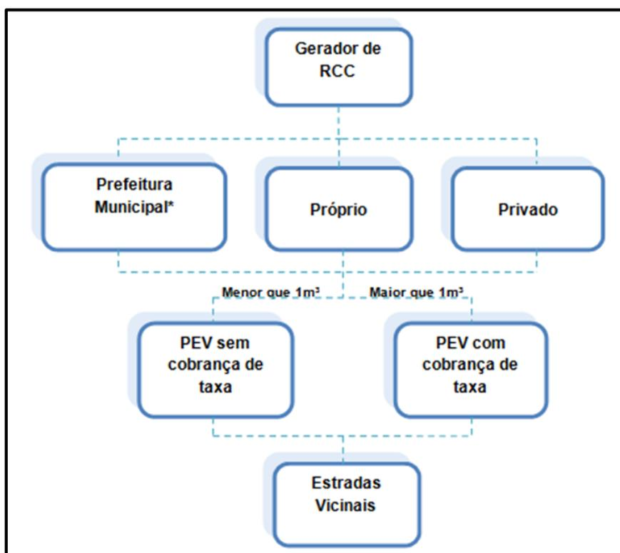
Figura 37 – Modelo proposto para coleta de RCC
