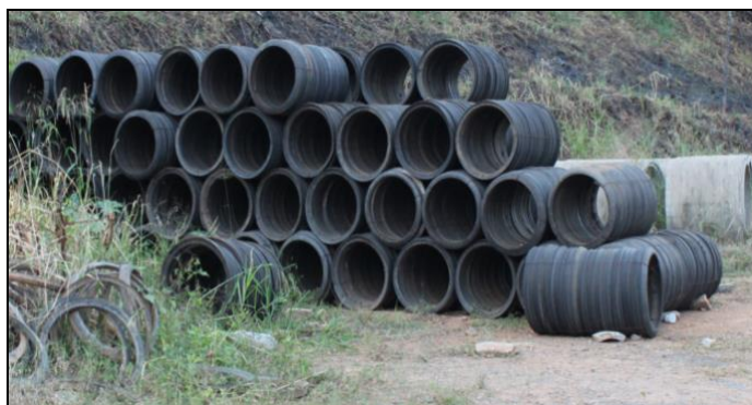
Figura 56 - Manilhas feitas de pneus usados
