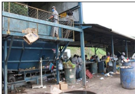
Figura 22 - Equipamento que direciona os resíduos para a bancada e balanças
