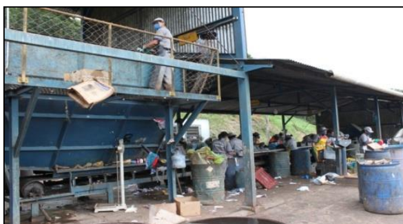
Figura 25 - Equipamento que Direciona os Resíduos para a Esteira e Balanças
